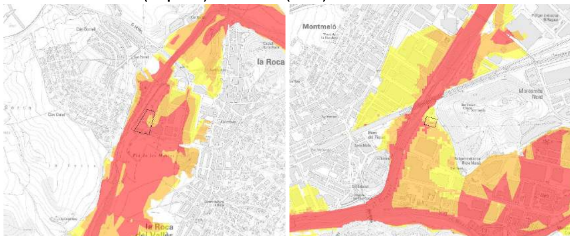
Imatge 31. Perill d'inundació fluvial (velocitat) i afectació a les subestacions convencionals de La Roca del Vallès (esquerra) i Montmeló (dreta) en la situació actual.
